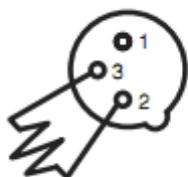
Терминатор уменьшает количество ошибок и позволяет избежать проблем при передаче сигнала и помех. Поэтому рекомендуется всегда использовать терминатор DMX (сопротивление  $120\Omega$ /4Вт между контактами 2 (DMX -) и 3 (DMX+) последнего устройства в цепи.
