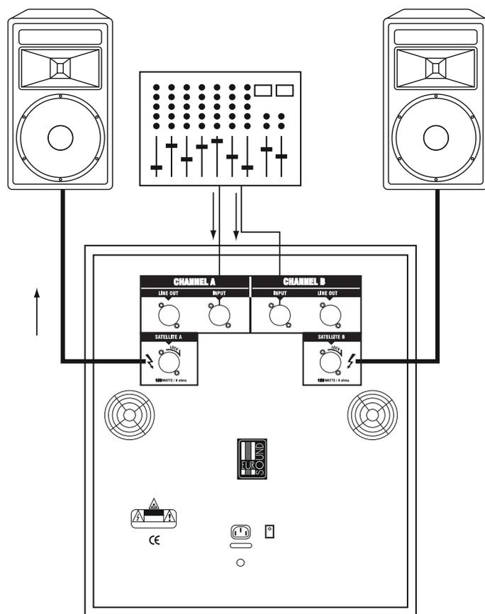
С помощью прилагаемых кабелей подключите сателлиты FOCUS-1100A-v2 к выходным разъемам SATELLITE left и SATELLITE right.
